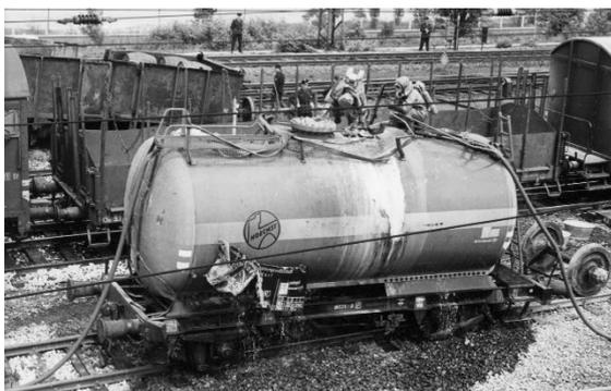
*Verunglückter Kesselwagen wird abgepumpt*
