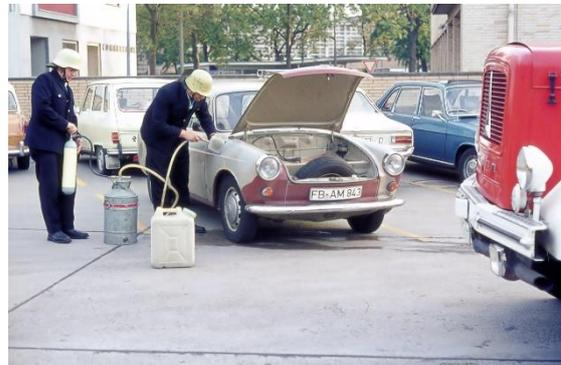
*Beispiel für die täglichen Kleineinsätze des RW-Oel: Absaugen von Kraftstoff mittels Pressluft.*
