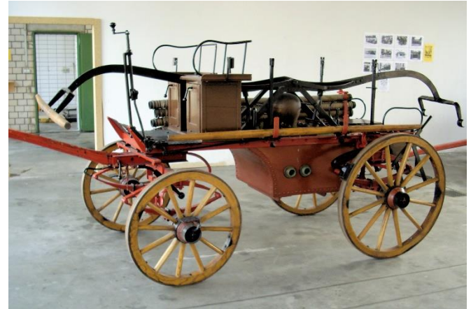
Handdruckspritze der Firma Koebe/Luckenwalde, im Frankfurter Raum vertrieben durch Maury/Offenbach
