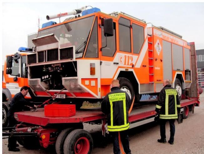
Auf dem Tiefladeanhänger der Feuerwehr festgezurrt, wird der „Falcon“ nach Enkheim transportiert. Gut erkennbar ist, dass die komplette Pumpenanlage fehlt.
