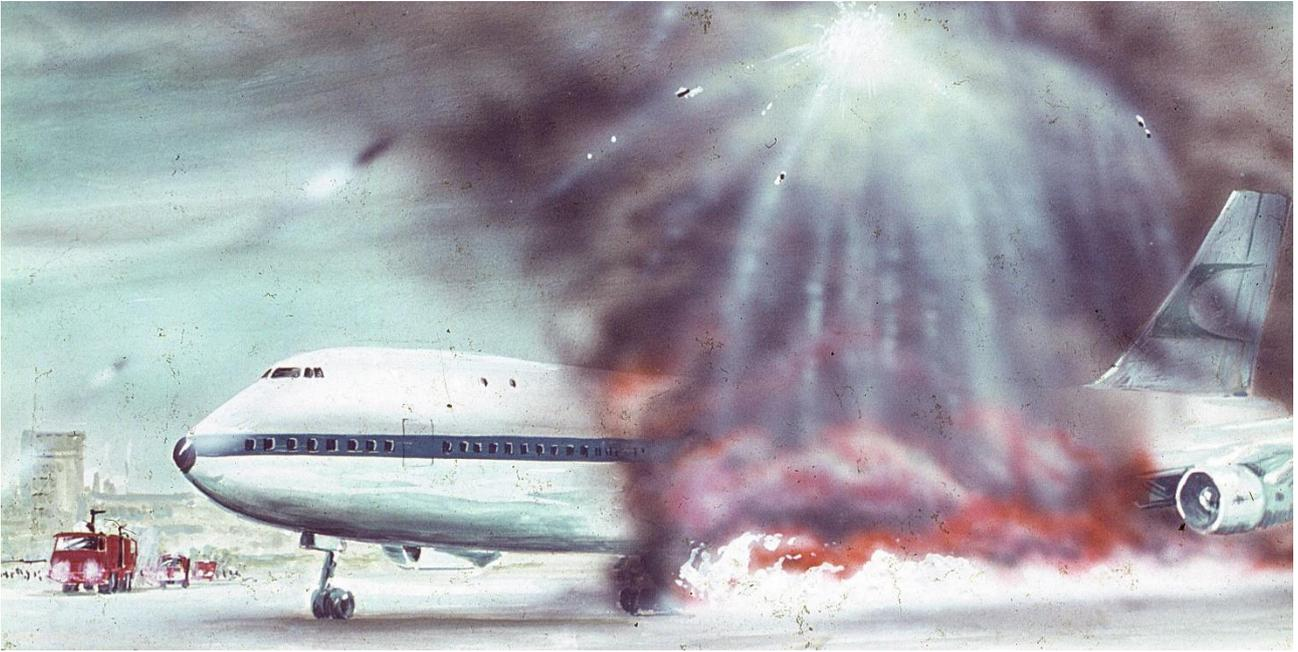
*Revolutionäre Achilles-Idee: Noch bevor die Fahrzeuge der Flughafenfeuerwehr vor Ort sind, explodieren Löschraketen über einem brennenden Flugzeug und erhöhen die Chance, Insassen lebend zu retten*
