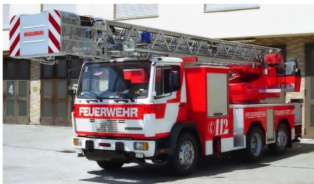
Erste Drehleiter mit Nachlauf-Lenkachse
