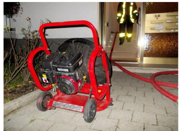
Heute ist der Einsatz von Lüftern bei Bränden in Gebäuden eine Standardmaßnahme der Feuerwehr
