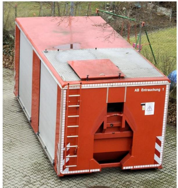
*Das Foto (hier des bereits neulackierten AB) zeigt die Klappe auf dem Dach, die vor Einsatzbeginn zu öffnen war*
