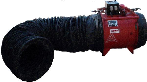
*„Großraumlüfter“ von Auer mit einer angeschlossenen Lutte*
