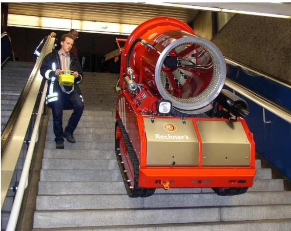
Vorführung: Ein Mitarbeiter der Fa. Rechners fährt an der U-Bahn-Station Konstablerwache ein LUF über den Treppenabgang in den U-Bahnhof
