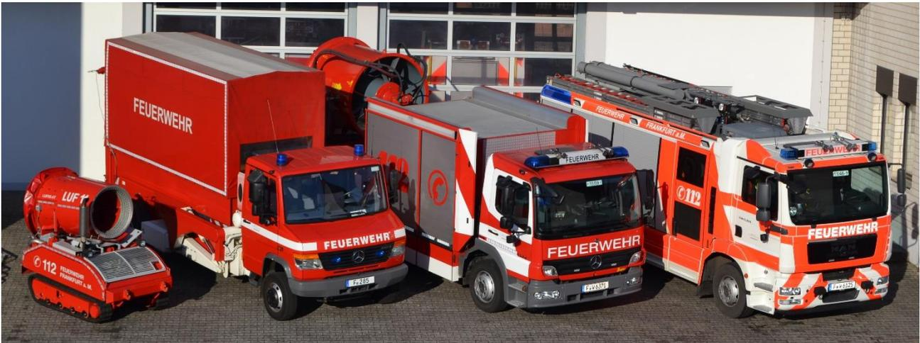
Einsatzzug der Feuerwache 11 zur Brandstellenbelüftung und -entrauchung: (v.r.n.l.) HLF, GW-Lüfter und WLF Typ Ruthmann mit LUF und Zusatzbeladung
