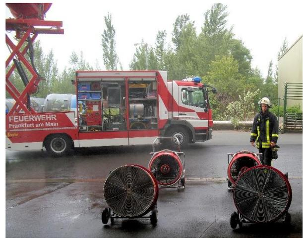
*Mobiler Großventilator, Überdruck- und Strömungslüfter vom GW-Lüfter gemeinsam eingesetzt*
