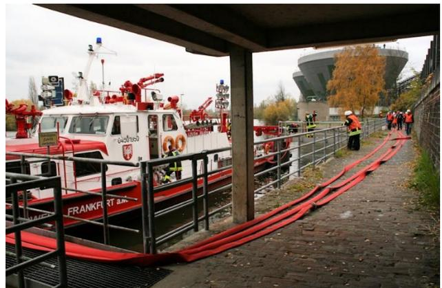
Feuerlöschboot der Berufsfeuerwehr im Werkshafen zur Sicherstellung der Wasserversorgung
