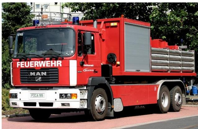
MAN Wechselladerfahrzeug, hier mit „AB-Pumpe“
