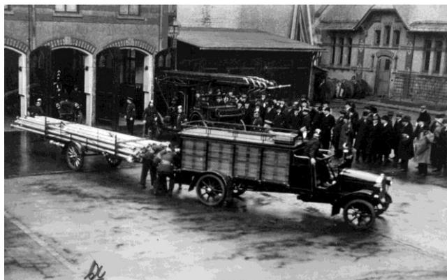
Vorführung Adler-Schlauchwagen mit Lanninger-Einachsanhänger für Schnellkupplungsrohre
