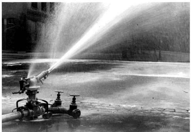
„Feuer-Abwehr-Kanone“ als Endstück eines Lanninger-Rohres eingekuppelt
