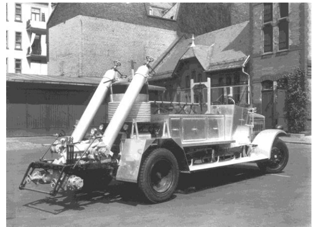
Als „TOTAL-Großgerät“ oder auch als „Pulverspritze“ wurde dieses Fahrzeug des Silberling-Löschzuges bezeichnet, das über eine Pulverlöschanlage und eine Feuerlöschkreiselpumpe verfügte.
