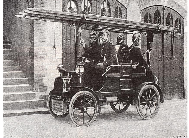
Adler-Motorwagen für die Feuerwehren mit einer Leistung von 4 PS im Hof der Feuerwache Burgstraße. Die Frankfurter Feuerwehr erprobte das Fahrzeug, zeigte aber ebenso wie andere Feuerwehren kein Interesse.
