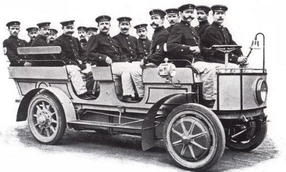
Lohner-Porsche Mannschaftswagen mit Elektroantrieb von 1904. Ebenfalls Batteriekasten zwischen den Achsen und Radnabenmotoren vorn. Deren Leistung wird mit 12-15 kW angegeben.
